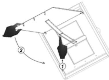
U kunt de kap sluiten door de klepschroef ... naar boven te drukken (1) en zo te ontgrendelen. Bij het ontgrendelen de onderplaat steeds ondersteunen (2)
