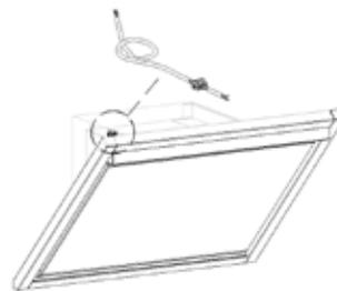
**ATTENTION !** Dans ce cas, la hotte doit impérativement être reliée à un coupe-circuit afin de pouvoir être mise hors tension en cas d'intervention.
