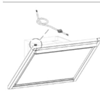
Elektrische Zuleitung durch Wandöffnung anschließen.
