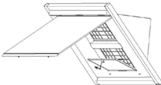
Zum Öffnen der Bodenplatte fassen Sie rechts und links in den Spalt der Randabsaugung und klappen die Bodenplatte nach unten herunter. Den Fettfilter können Sie am Griff nach unten herausziehen. Nach der Reinigung den Fettfilter abtropfen und trocknen lassen. Sie können den Fettfilter auch in der Geschirrspülmaschine reinigen.
